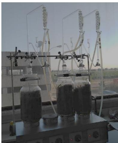
Volumen total y rendimiento de aceite esencial de lavandín extraído por destilación con cohobación durante 4 horas mediante destilador Clevenger en laboratorio (n=2)
